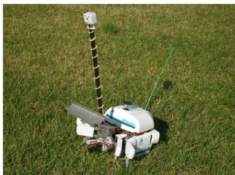
(1)伸縮腕による作業 腕先を伸ばし狭所・高所作業に対応 撮影や薬剤噴霧、塗装など
